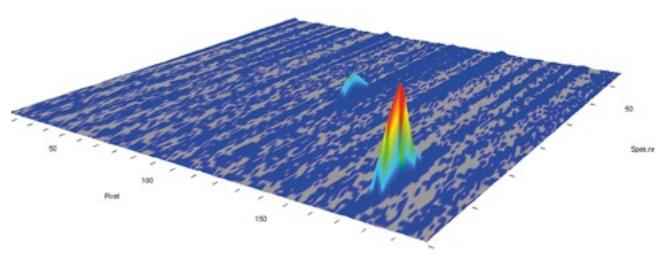
3D спектр после автоматической коррекции фона
