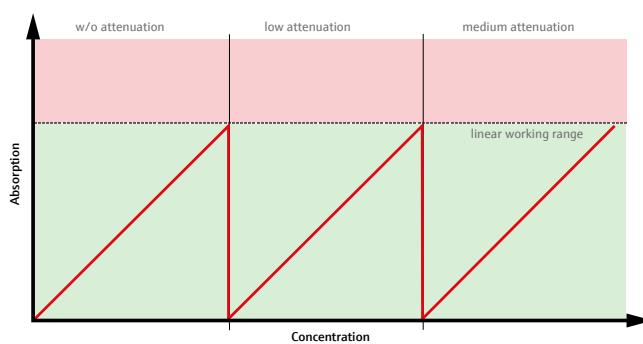
Система электронного ослабления сигнала позволяет сохранить линейность калибровки для широкого диапазона измерения даже для высоких концентраций.
